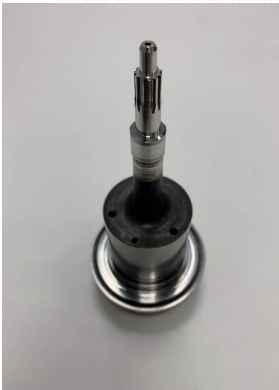
Slika 7: Popravljen pogonska zobniška gred
