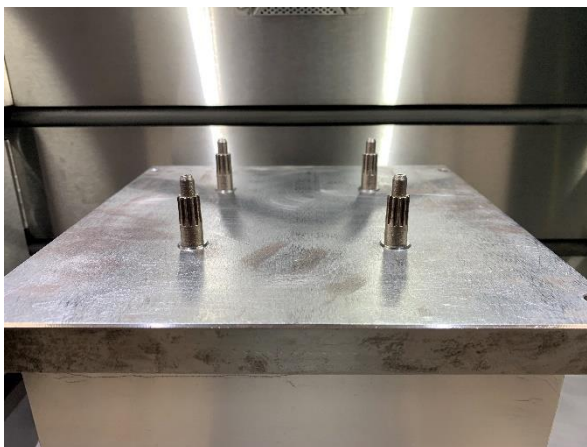
Slika 6: Mehanski del zobnika neposredno po DMLS procesu
