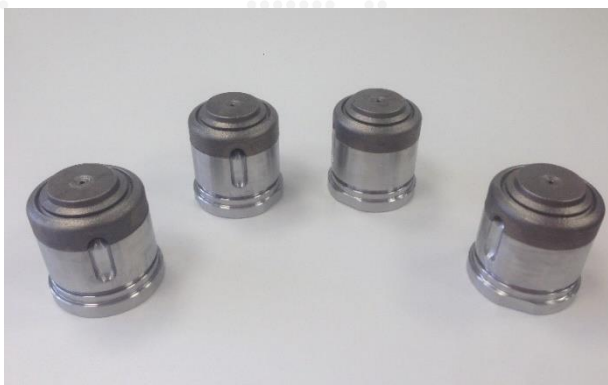
Slika 2: Hibridni DMLS tisk [1]
